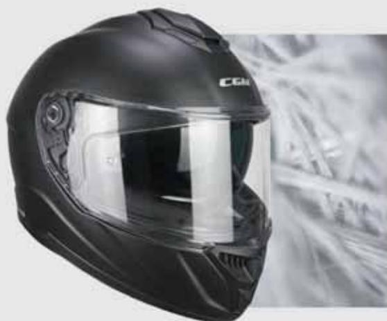
La calotta è realizzata in fibre composite amalgamate e rese solide grazie all'utilizzo di resine termoindurenti in vinilestere con base epossidica. L'utilizzo di fibre composite permette una buona resistenza alla forza dell'urto abbinata ad una maggiore leggerezza, le calotte in fibra inoltre non risentono degli sbalzi di temperatura e hanno una migliore resistenza ai raggi UV.
